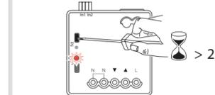
La LED de fonction s'allume suivant la fonction programmée. Exemple : récepteur programmé sur la fonction **Montée, stop par interrupteur**.
