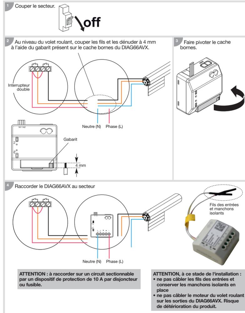
ATTENTION : à raccorder sur un circuit sectionnable par un dispositif de protection de 10 A par disjoncteur ou fusible.
