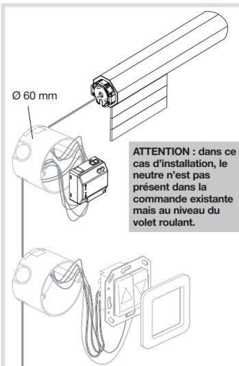
ATTENTION : dans ce cas d'installation, le neutre n'est pas présent dans la commande existante mais au niveau du volet roulant.
